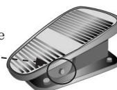
Libérer le boulon d'arrêt en utilisant la clé appropriée et visser le verrou d'arrêt jusqu'à ce qu'il contre-écrive.
